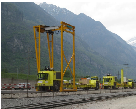
Zweirichtungsfahrzeug für den Kabeleinzug.
