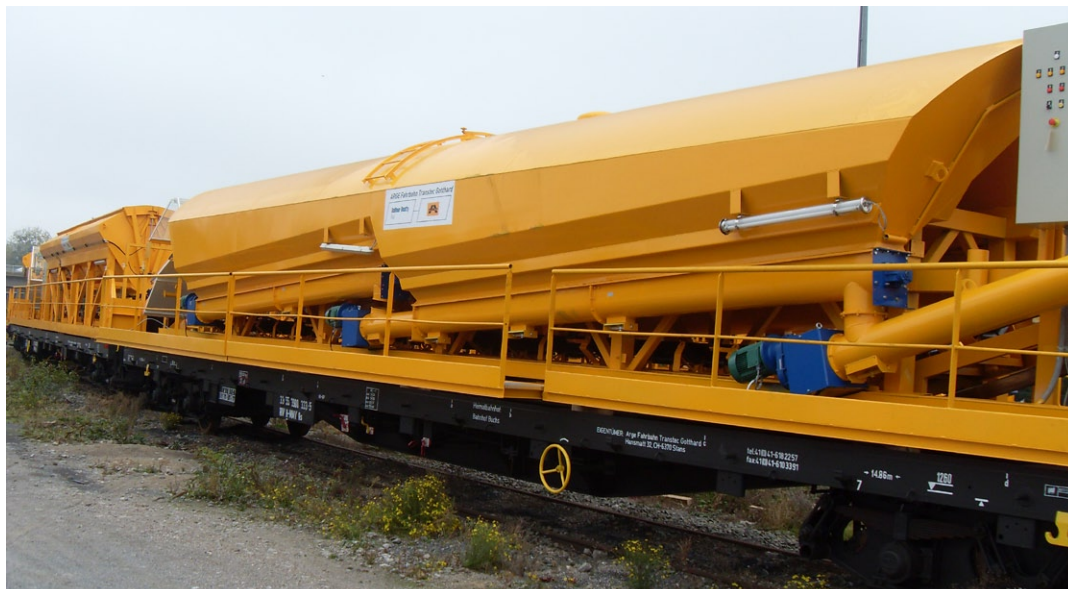
Ein Zementwagon des Betonzuges.
